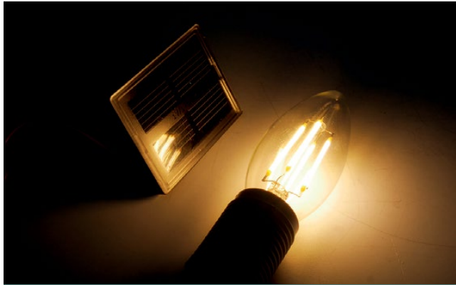
Шаг 1. Подсоедините солнечную панель к нагрузочному резистору и осциллографу. Расположите её напротив исследуемой лампы. Выключите или закройте все остальные лампы в помещении.
